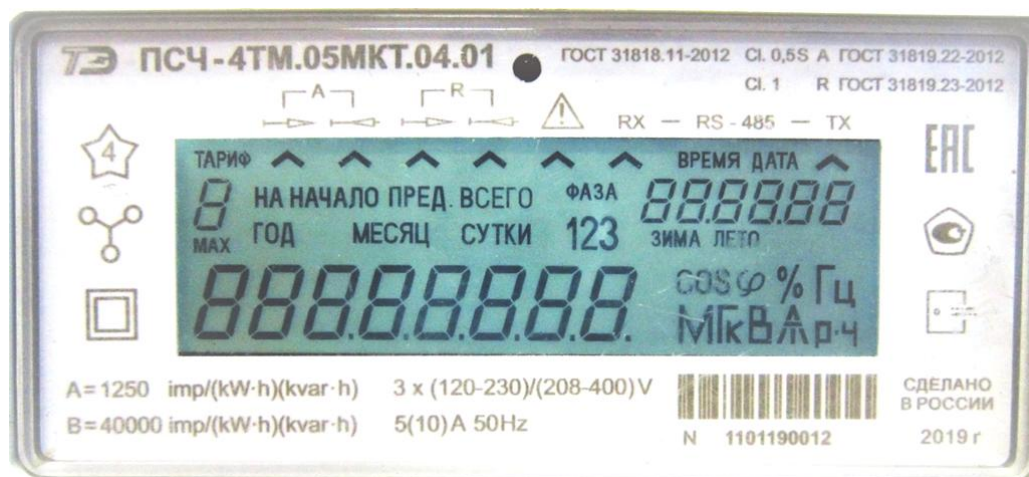
Рисунок 5 – Внешний вид ЖКИ с включенными элементами индикации
